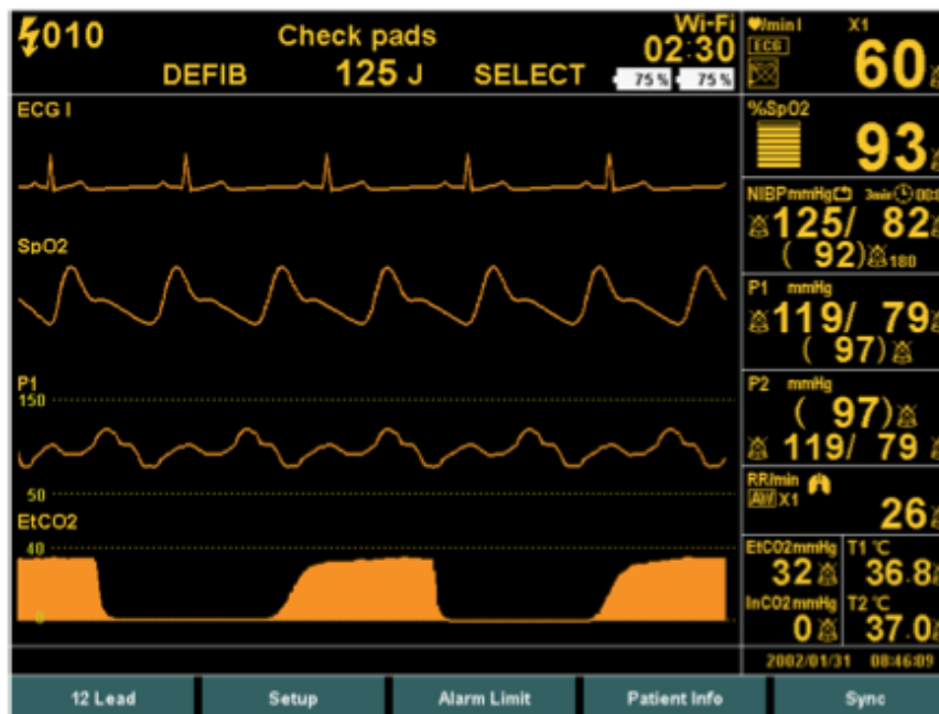
Figura 15. Pantalla negra-amarilla (4 formas de onda, Modo de Desfibrilación, Opción completa)
